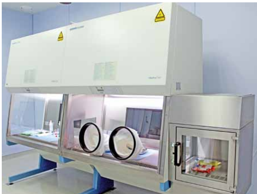
Abb. 2: Zytostatika-Isolator mit vorgeschalteter Sicherheitswerkbank und Schleuse
