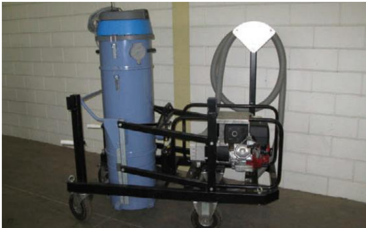
Handliche kleine Saugereinheit für schwieriges Gelände oder zum Einsatz auf einer Hebebühne. (Bild: NVWA)
